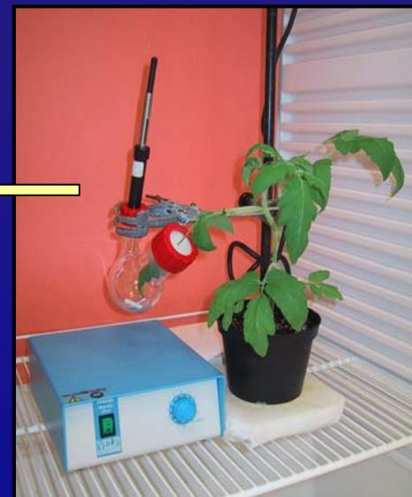
Figura 4. Análisis de contaminantes en muestras de planta mediante SPME
