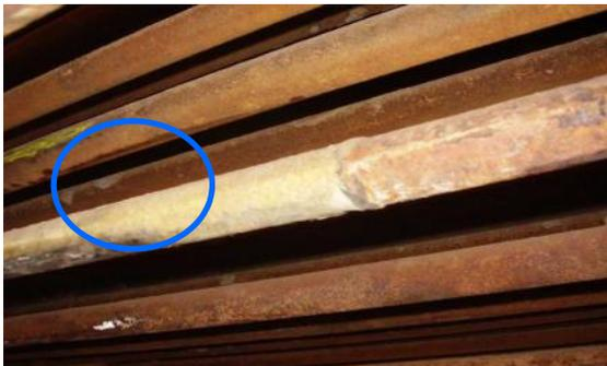
DESGASTE DEL RECUBRIMIENTO DEL TESTIGO COLOCADO EN LA PARADA DE 2007
