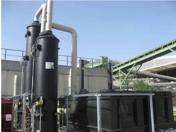
Paralelamente se ha montado y puesto en marcha una planta piloto de pruebas en la Universidad, similar a la mostrada en la foto, pero de un tamaño inferior (300 m<sup>3</sup>/h). Esta planta servirá para ajustar los modelos de simulación del proceso de absorción química con Chemcad® y para estudiar condiciones extremas. La planta tratará mezclas sintéticas de gases, lo cual permite el uso de un amplio rango de concentraciones.
