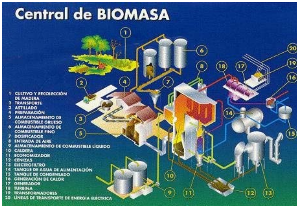
Fig.21. Central de combustión de biomasa. (Fuente: IDEA)
