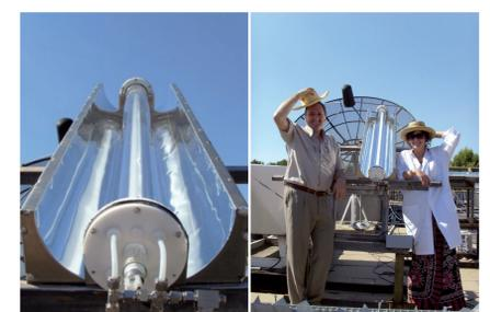
Fotorreactor anular híbrido para empleo de fotocatalizadores soportados transparentes con irradiación solar y/o artificial. Trazado del CPC.
