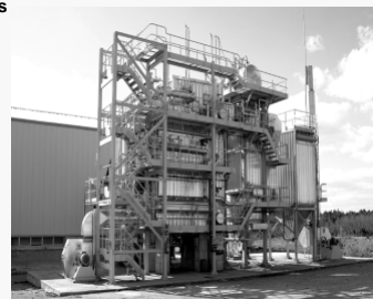
Planta experimental de demostración de lecho fluidizado burbujeante de 3.5 MWt
