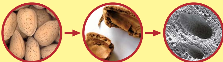
Figura 3. Transformación de la cáscara de almendra en carbón activado.
