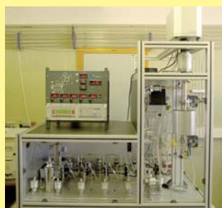
Figura 3. Transformación de la cáscara de almendra en carbón activado.
