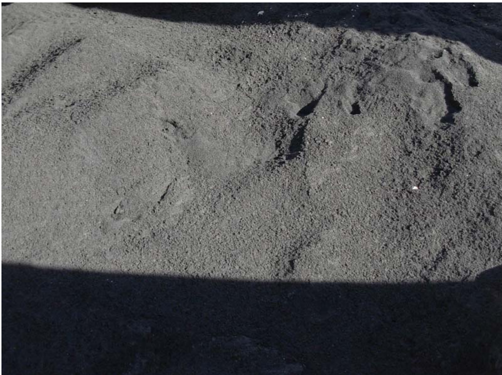
Vista del polvo de caucho procedente de neumáticos fuera de uso (NFU)
