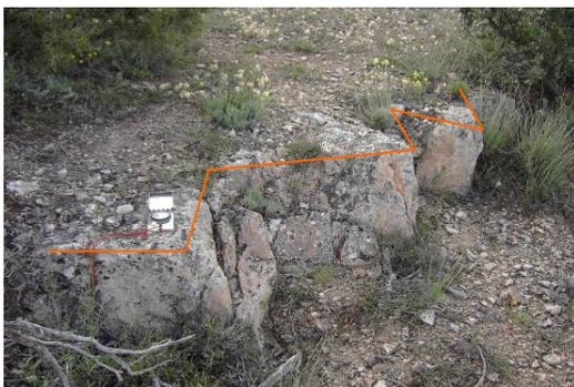
*Fotografía 2. Marcas de posibles frentes de explotación de pequeñas canteras abandonadas. Extracción a favor de líneas preferentes de fracturación de las calizas. La forma característica en "picos" señalada con la línea naranja se repite en numerosos puntos en los bordes superiores de las cárcavas, ya en la zona de montera de carbonatos.*
