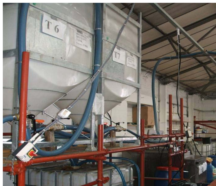
Figura 14. Tanques donde se realiza el proceso de transesterificación de aceite usado de cocina (Reino Unido)
