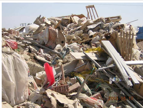
Imagen N°. 5. Escombros de Construcción típico. Restos mezclados.
