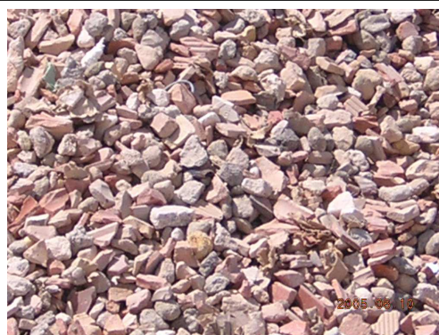
Imagen N°. 6. Escombros de Construcción limpio y seleccionado habilitado para su reciclaje.
