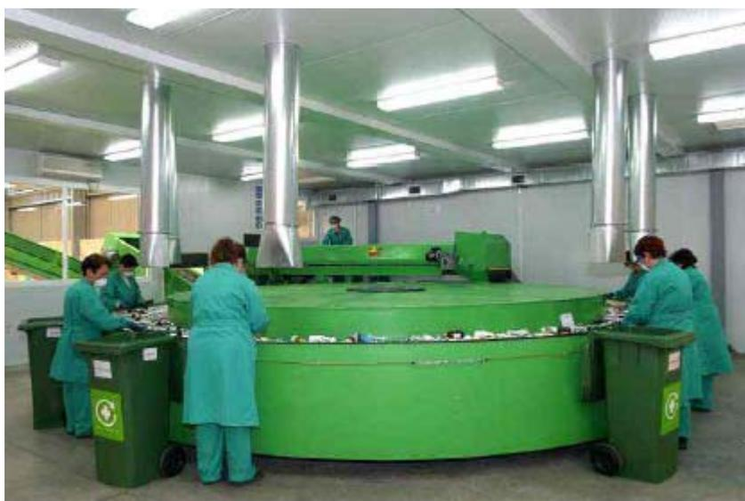
*Foto: Un detalle de la cabina de triaje en la que se clasifican los materiales de los envases y los residuos de medicamentos*
