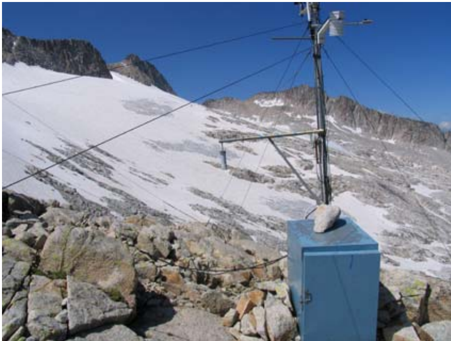
Figura 2: vista de la torre de aparatos y armario de batería y software. Al fondo el glaciar de Aneto (septiembre 2007). Foto: J. del Valle.
