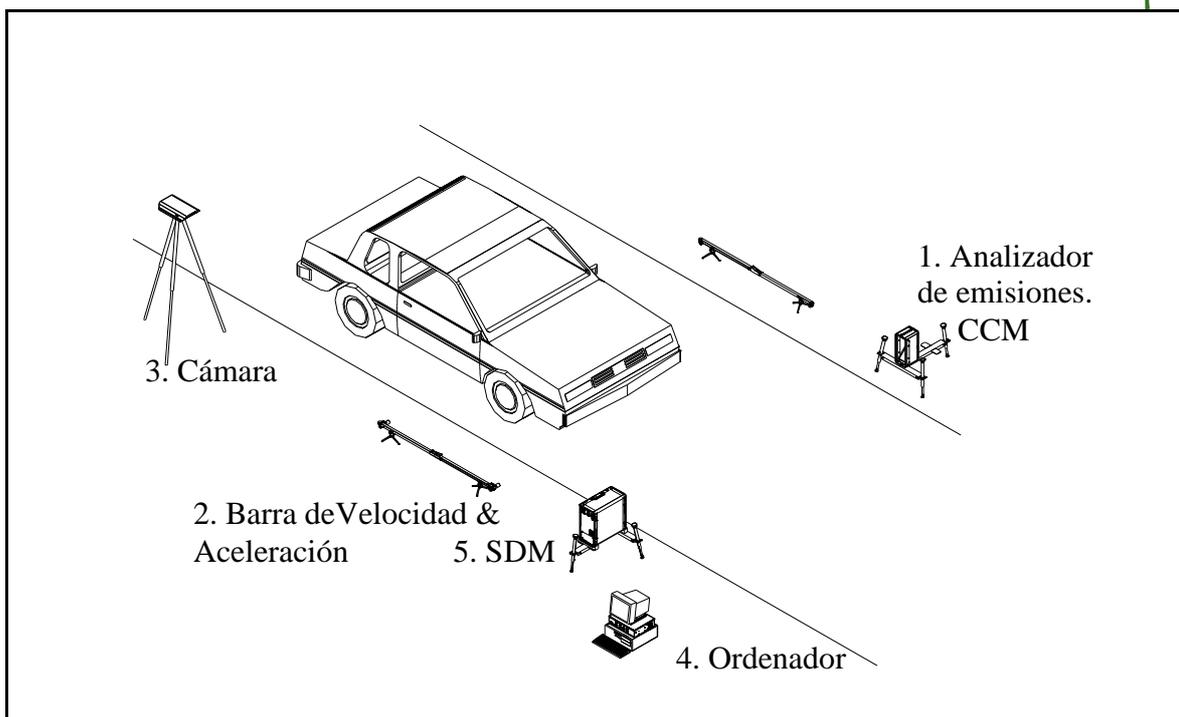
El método se basa en las medidas de absorción de la radiación emitida en las diferentes longitudes de onda, por parte de las especies contaminantes de interés presentes en la pluma de escape del vehículo.
