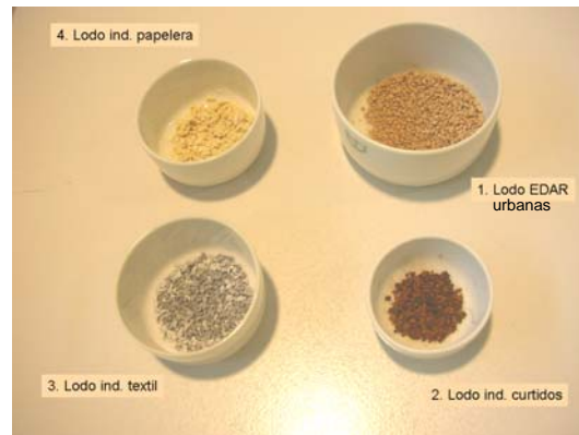
Figura 5: Aspecto de las cenizas de cada muestra de lodos después de su calcinación
