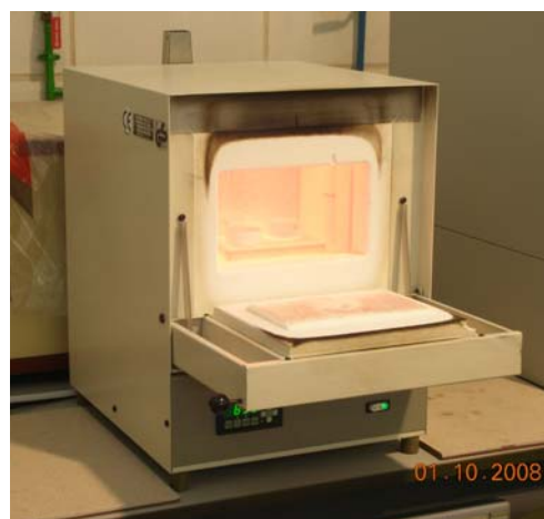
Figura 4: Muestras de lodos introducidas en horno mufla a 900°C
