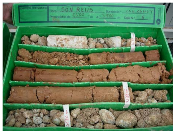
Ilustración 7. Ejecución de sondeo de control. Detalle de un tramo de uno de los testigos extraídos.
