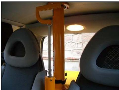
13. Detalle del accionamiento manual del mástil
