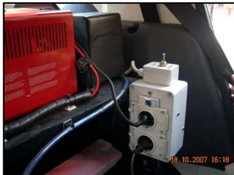
8. Detalle interruptor accionamiento del mástil, y conexiones y protecciones eléctricas.
