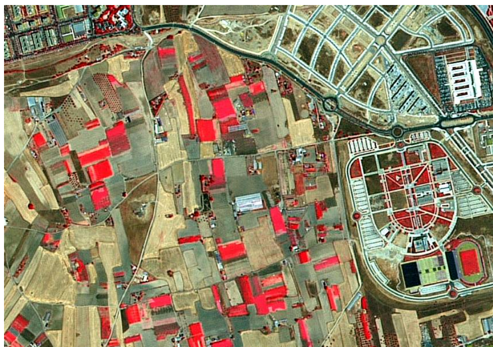
Figura 5: Imagen SPOT 5 de la cobertura PNT 2005. Falso color infrarrojo. Tamaño de píxel 2,5 m ("Pansharpeneo")
