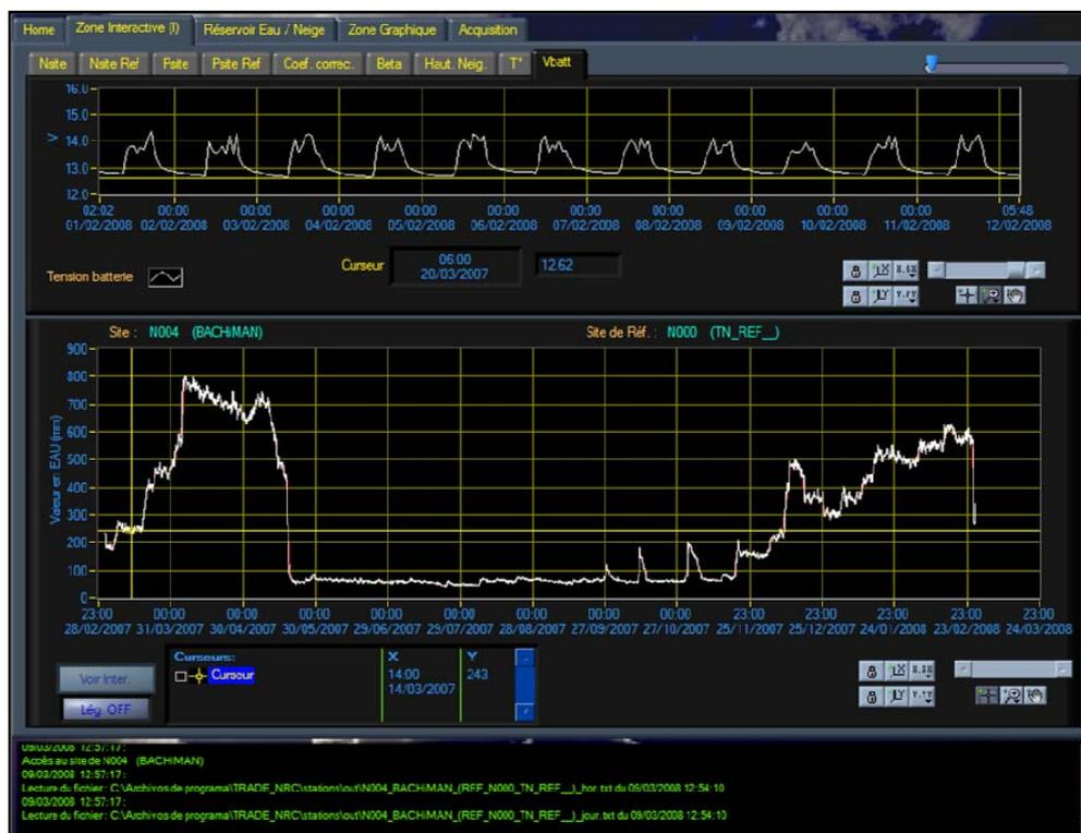
El parámetro más importante de todos los que aporta el TRADE es el equivalente en agua. Para obtener dicho valor es necesario tener ubicado perfectamente el emplazamiento (altitud, coordenadas), haber recibido los valores de todos los sensores del emplazamiento y los valores del telenivómetro de referencia, y además haber ajustado perfectamente todo el sistema.
