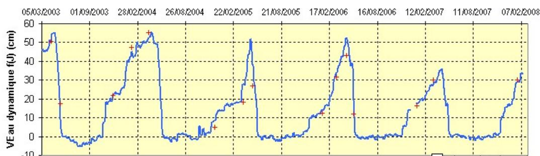
La siguiente gráfica del software TRADE muestra el equivalente en agua de la reserva nivel de las distintas subcuencas que conforman una determinada cadena montañosa.
